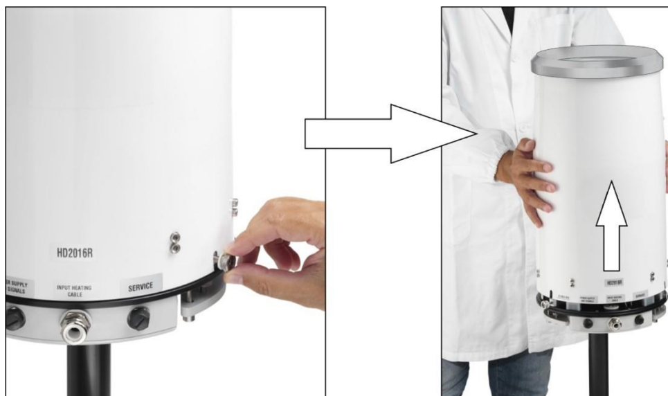
Fig. 10.2: rimozione del mantello
