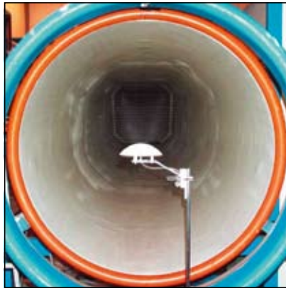
Enchufe de presión estático puesto en la galería aerodinámica
