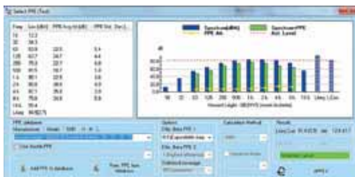
Noise Studio: Modulo NS1 Protezione Lavoratori: analisi dell'efficacia del DPI.
