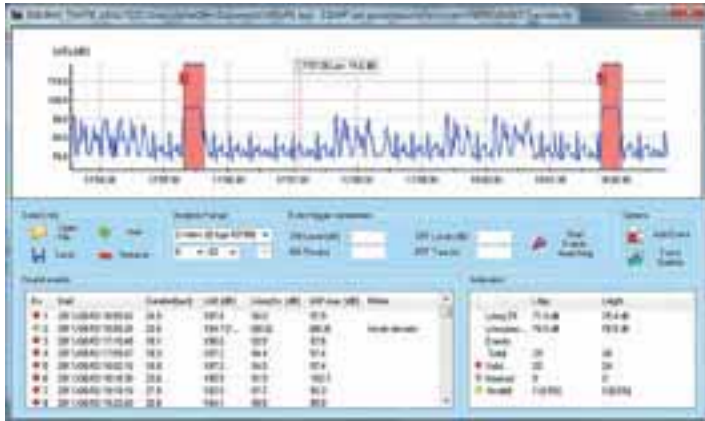
Noise Studio: Modulo NS2A "Inquinamento Acustico": rumore da traffico ferroviario, analisi sulle 24 ore con identificazione automatica dei transiti dei treni.
